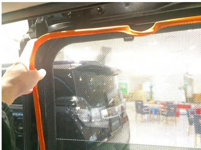
④純正の後席用サンシェードつき車両の場合は、純正シェードのフックを避ける様にしてください。
