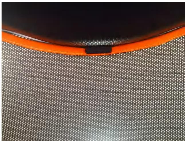
⑥最後にクリップのツメにシェードのフレームを挿入します。以上で完了です。
