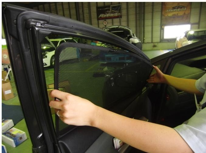
②レーザーシェードを上面のウィンドウフレームにマグネットで固定します。
