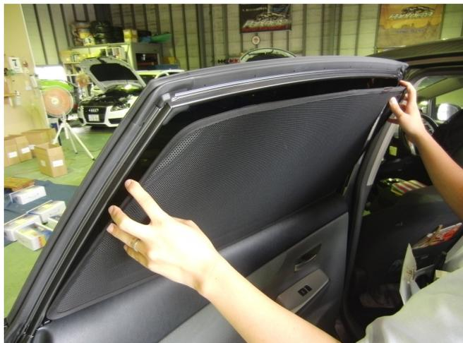
②レーザーシェードを上面のウインドウフレームにマグネットで固定します。
