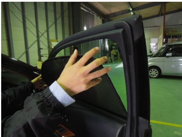
②レザーシェードの上面をウインドウフレームにマグネットで固定します。
