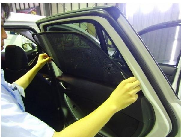
②リアウィンドウのレールにレーザーシェードの上面を合わせます。
