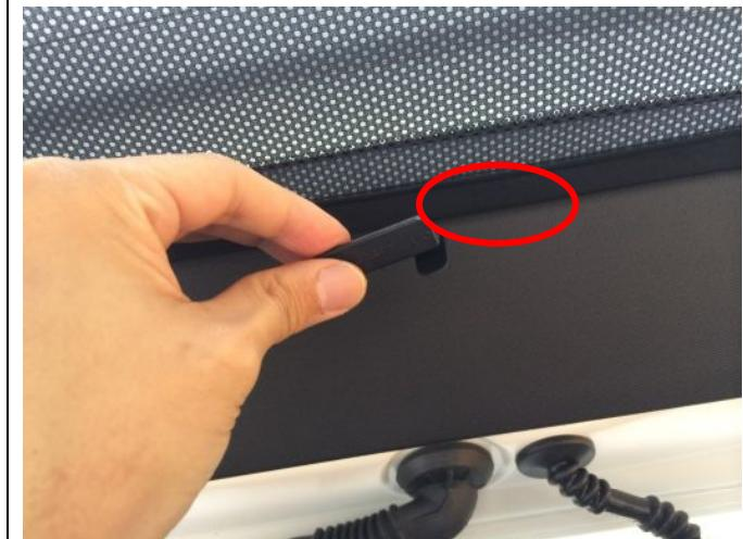
丸印がクリップの位置です。画像の向きで装着してください。(2つのツメが内装の奥に入れります)
