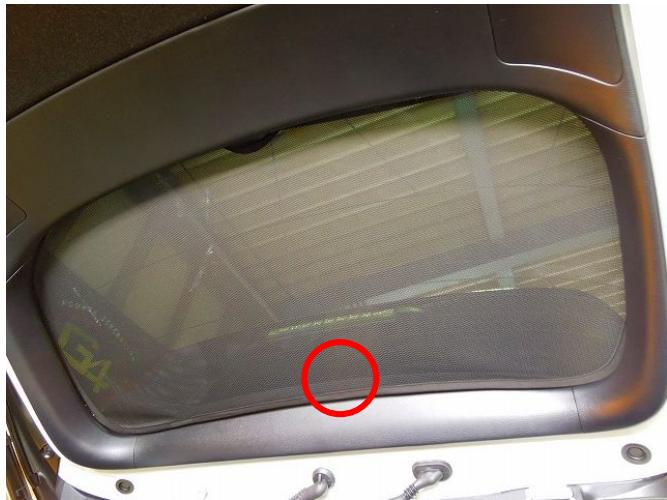
④ クリップのツメにシェードの枠を挿入します。
