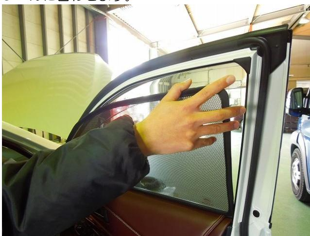
②レザーシェードの上面をウインドウフレームにマグネットで固定します。
