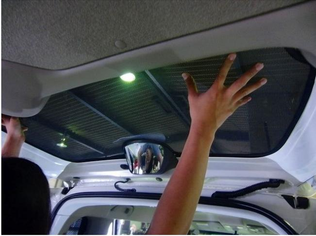
②後方確認用のミラーの周囲にリアシェードを押し込みます。
