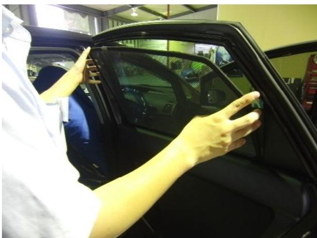
②レーザーシェードをウインドウフレームの上面にマグネットで固定します。
