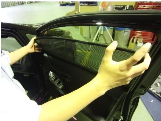
②レーザーシェードをウィンドウフレームの上面にマグネットで固定します。
