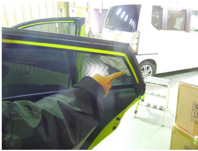
②レザーシェードを上面のウインドウフレームにマグネットで固定します。
