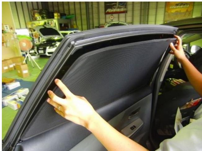
②レザーシェードを上面のウインドウフレームにマグネットで固定します。
