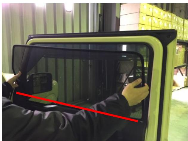
② レーザーシェード上面をウインドウフレームに押し当てます。
