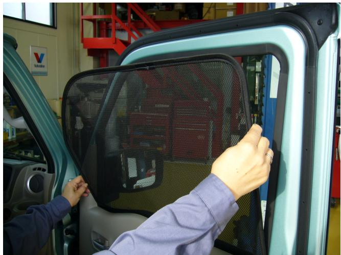
②レーザーシェー上面をウインドウフレーム磁石で固定します。
