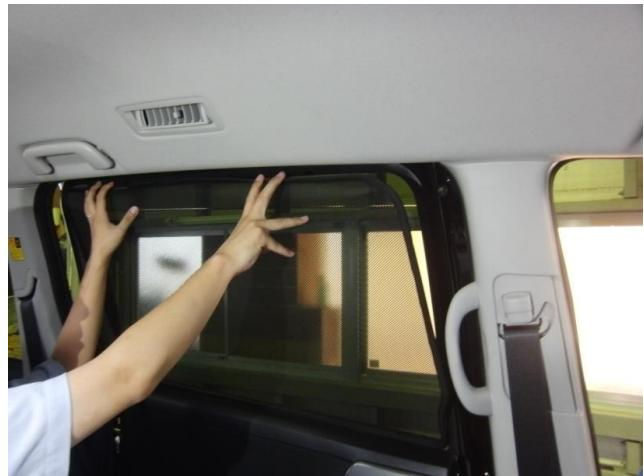
③シェードの上面をフレームにマグネットで固定します。
