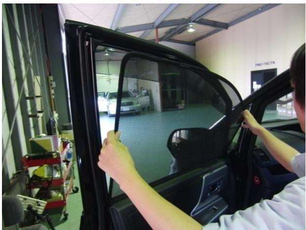
②レーザーシェードの上面をマグネットで固定します。
