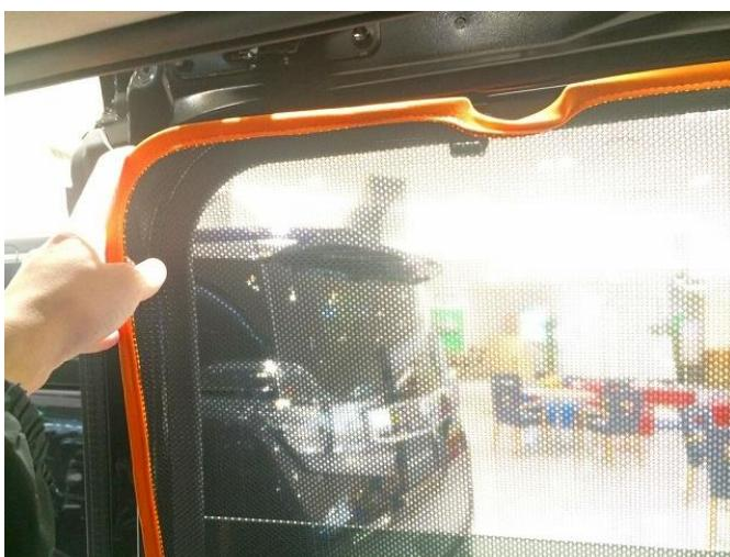
④純正の後席用サンシェードつき車両の場合は、純正シェードのフックを避ける様にしてください。
