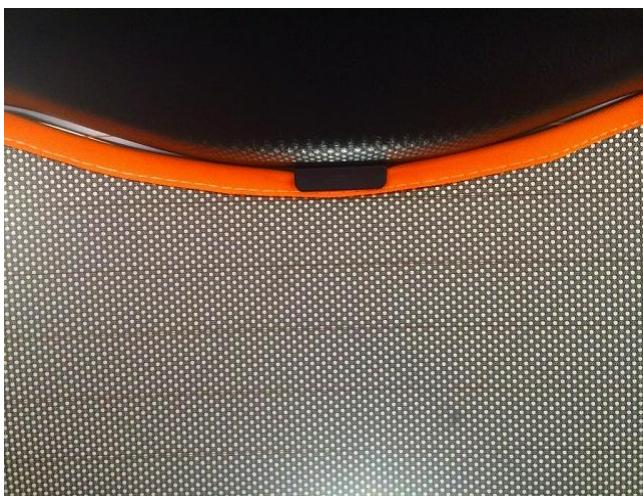
⑥最後にクリップのツメにシェードのフレームを挿入します。
