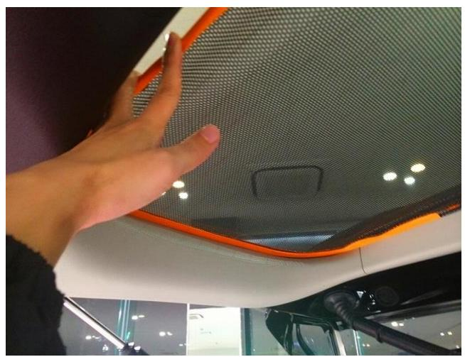
③付属のS型クリップを内装パネルの中央付近2箇所（赤丸印付近）に装着します。
